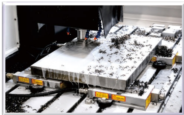
龍門大型工件加工應用 (自由組合磁力夾具之數量、位置及間距)
